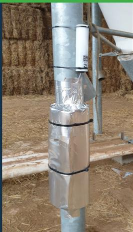
**Une antenne :** elle envoie les informations mesurées par le capteur.
